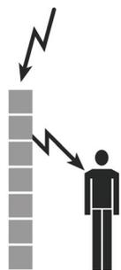
⇨ **Berührungsspannung:** Beim Berühren von metallenen Objekten wie Flutlicht- oder Fahnenmasten, Blitzableitern usw. fließt ein Teil des Blitzstromes durch den Menschen.
