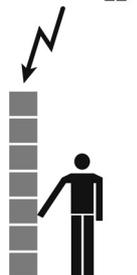
⇨ **Schrittspannung:** Ausgehend von der Einschlagstelle breitet sich der Blitzstrom im Erdboden nach allen Richtungen aus.
