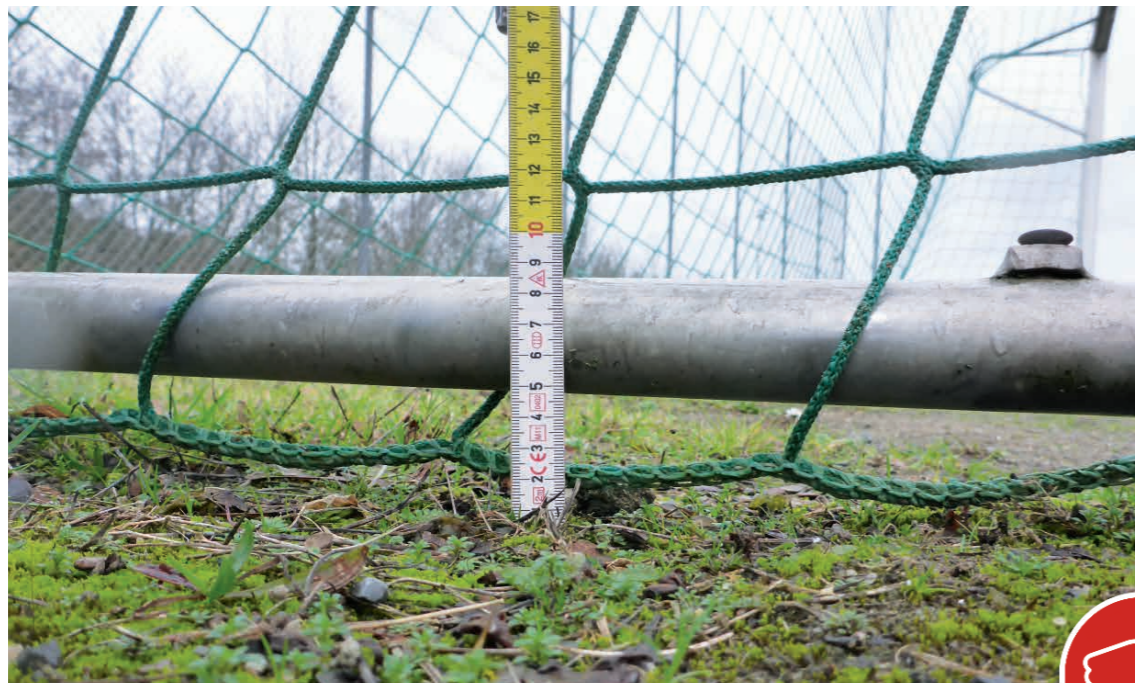
Bild 24: Höhendifferenz zwischen Bodenrahmen und Boden
