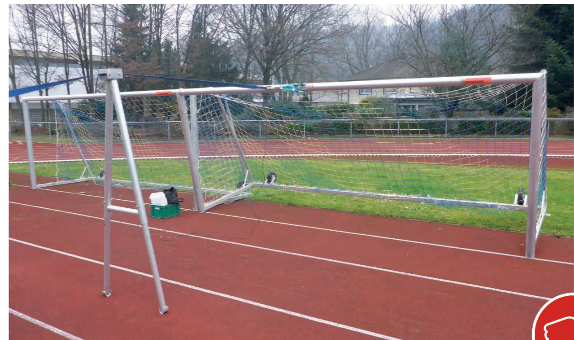
Bild 7: Wenn sich das Tor bei der Standfestigkeits- und Festigkeitsprüfung gemäß der sicherheitstechnischen Anforderungen nach DIN EN 748 hebt, ist die Standfestigkeit nicht ausreichend.
