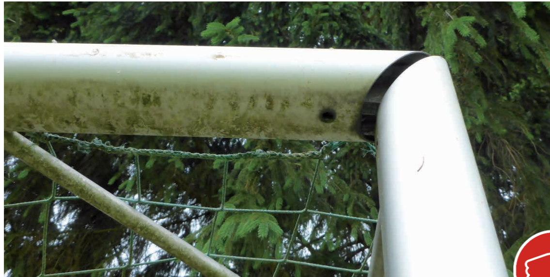
Bild 11: Hier fehlen Schrauben, so dass Pfosten und Torlatte nicht mehr fest miteinander verbunden sind.
