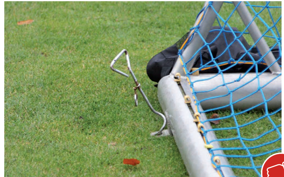
Bild 9: Überstehender, nicht vollständig eingeschraubter Spiralanker
