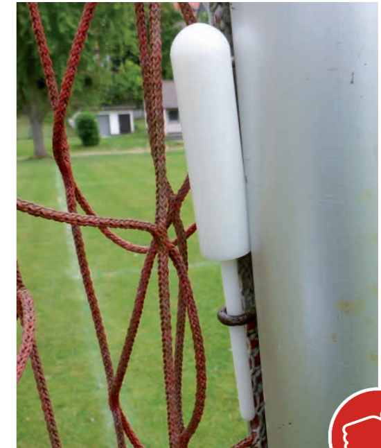
Bild 34: Prüfkörper für Fingerfangstellen
